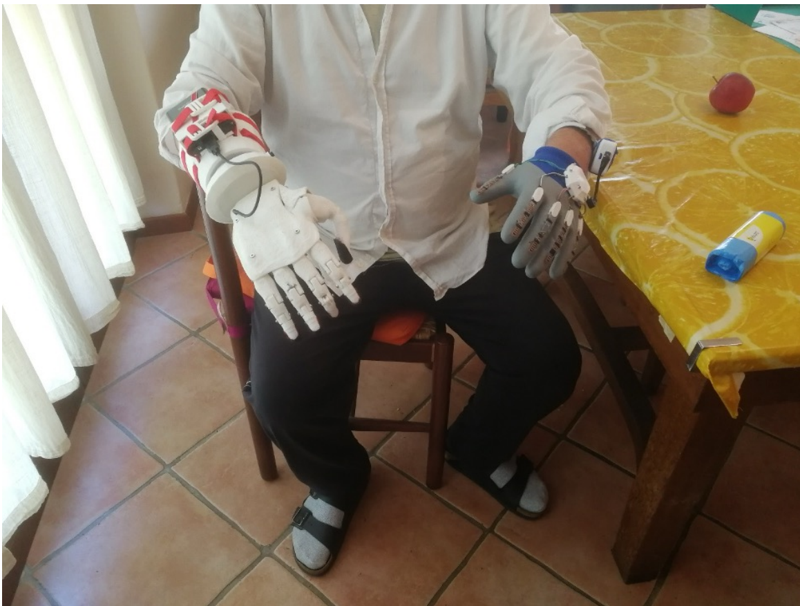
Paziente che indossa la protesi 3D. Sull'altra mano, il guanto che ne controlla i movimenti.
